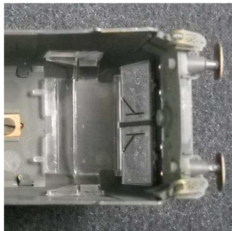
Démontez les conduits en lucites et les cabines car ces deux pièces sont solidaires. Ensuite séparez les conduits et les cabines. Supprimez la partie en plastique comme l'indique la photo suivante. Pour vous faciliter le montage du kit il est conseillé de démonter les faces avant.
